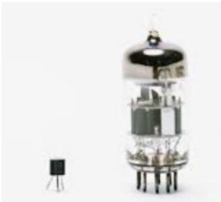
Comparazione tecnologica tra un transistor e un micro-valvola
