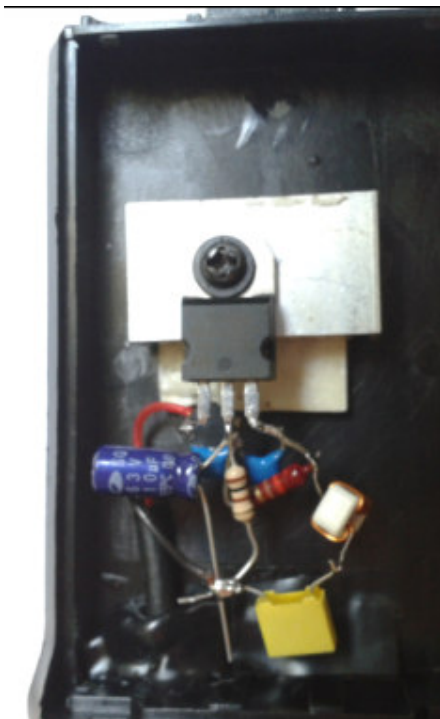
interno con il nuovo 78s05 e resistenze
