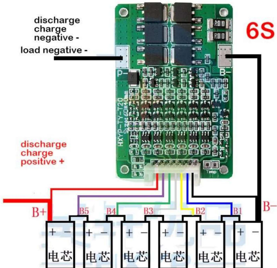
Se invece si deve fare un **pacco batteria per un'avvitatore** quello sopra non va bene , ma meglio usare :
