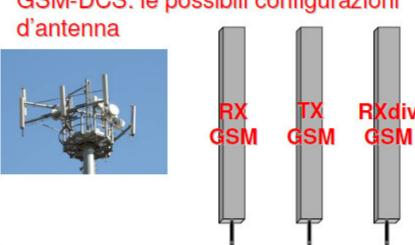
Colocazione di nodeB UMTS con BTS GSM-DCS: le possibili configurazioni
