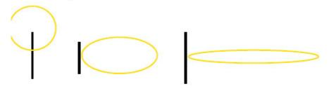
$EiRP [dBW] = P_{connettore} [dBW] + G_{antenna} [dBi]$
